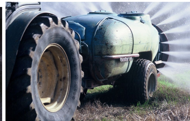
NEUMÁTICOS DE BAJA PRESIÓN (menos presión y mayor anchura) Y CONCENTRAR PISADAS (tráfico controlado)
