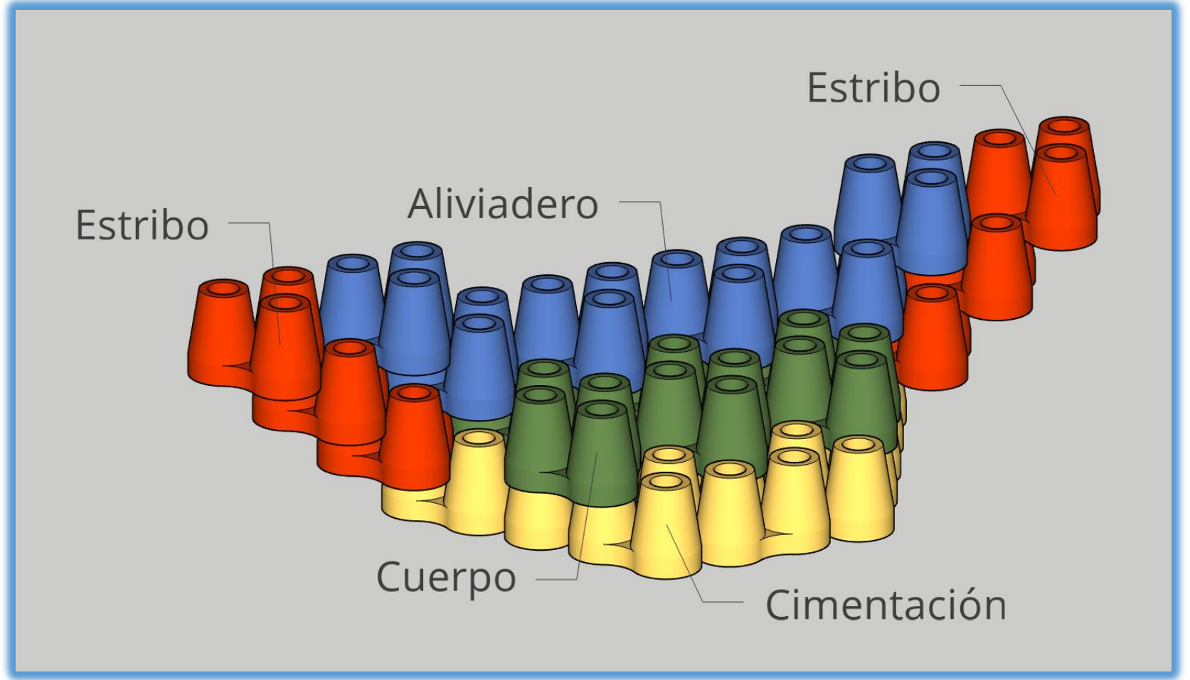
Dimensiones del elemento modular apilable y croquis de un dique de tres niveles
